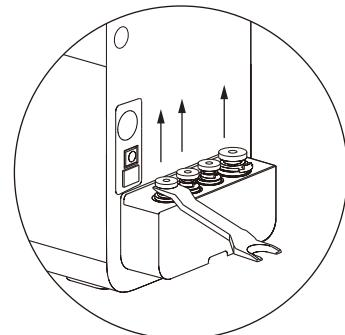
b. Conecte la entrada de agua y la válvula de bola de tres vías.
