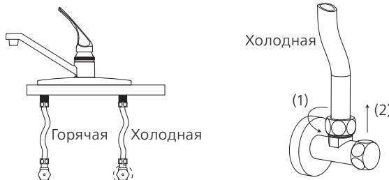
б. Наденьте гайку трехходового шарового крана на полиэтиленовую трубу 3/8" (9,525 мм) и вставьте трубу в отверстие трехходового шарового крана. Затяните гайку гаечным ключом.
