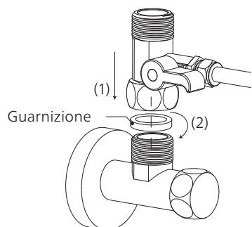
d. Collegare il tubo dell'acqua fredda con la valvola a sfera a tre vie e avvitare serrando con una chiave. Non dimenticare la guarnizione nel tubo dell'acqua fredda durante l'installazione.
