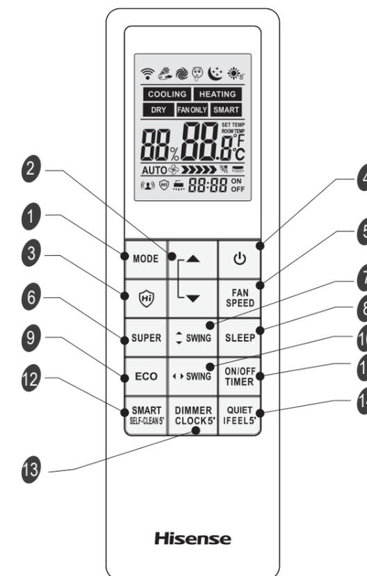
Когда кондиционер выключен, а на пульте ДУ выбран режим охлаждения или осушения, нажмите и удерживайте кнопку SMART в течение 5 сек для включения функции самоочистки замораживанием ICE Clean.\*\*
