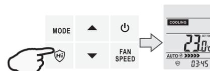
**Примечание:** будучи запущенным, ионизатор вырабатывает большое количество ионов. Для поддержания оптимального количества ионов в воздухе помещения, функция будет работать циклами по 140 минут (140 минут работы / 140 минут отдыха). Ионизатор останавливает свою работу в случае остановки вращения вентилятора внутреннего блока (например, в режиме теплого пуска – когда кондиционер был переключен в режим нагрева, и вентилятор внутреннего блока еще не запустился).
