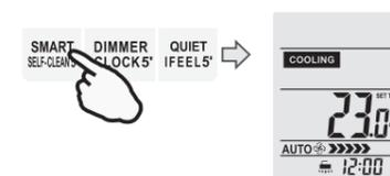
Нажмите кнопку OFF или SMART SELF-CLEAN5\*, чтобы отключить режим самоочистки замораживанием ICE Clean, индикатор исчезнет.
