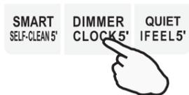
Если подсветка дисплея внутреннего блока выключена, кондиционер включит ее на 5 секунд при получении любого сигнала.
