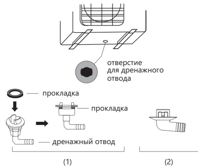
**Примечание:** изображение конструкции дренажного патрубка приведено для справки. Конструкция дренажного патрубка вашего кондиционера может отличаться (например, может отсутствовать резиновая прокладка)
