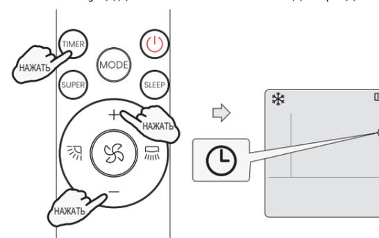
**Настройка таймера на выключение кондиционера:** когда кондиционер включен (работает), нажмите кнопку **TIMER**, далее кнопками **+** и **-** выберите желаемое время, через которое кондиционер выключится: «0,5ч-1ч-1,5ч...10ч-11ч...24ч-OFF» После окончания настройки времени таймера, нажмите кнопку **TIMER** для подтверждения, или не нажимайте кнопки в течение 3 секунд для автоматического подтверждения.
