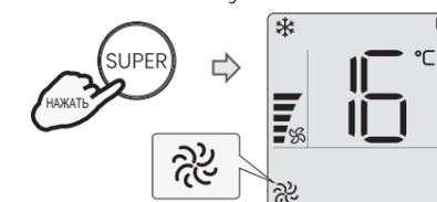
Нажмите кнопку **SUPER** в режиме нагрева. Установленная температура автоматически изменится на +30 °C (86 °F). Скорость вентилятора изменится на «Авто».
