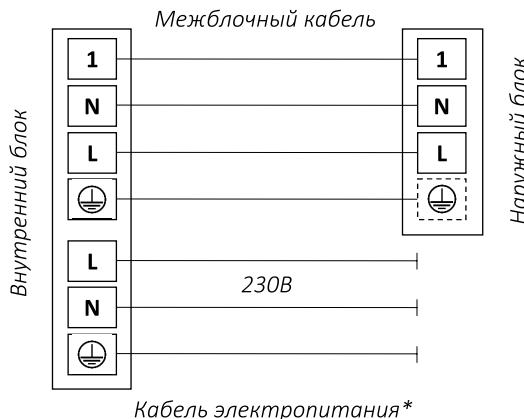
\*Кабель электропитания подключен к плате управления внутреннего блока
