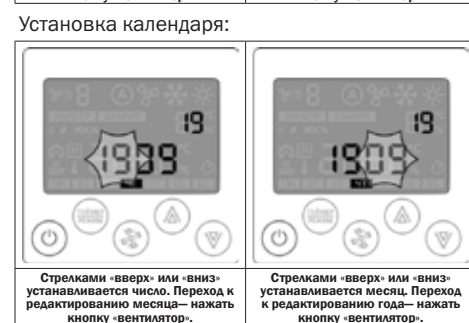
Стрелками «вверх» или «вниз» устанавливается число. Переход к редактированию месяца — нажать кнопку «вентилятор».
