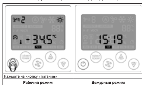
Стрелками «вверх» или «вниз» устанавливаются часы. Переход к редактированию минут — нажать кнопку «вентилятор».
