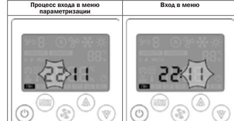
Стрелками «вверх» или «вниз» устанавливаются часы. Переход к редактированию минут — нажать кнопку «вентилятор».
