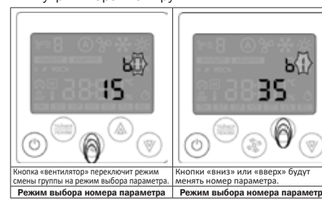
Кнопка «вентилятор» переключит режим смены группы на режим выбора параметра. Кнопки «вниз» или «вверх» будут менять значение выбранного параметра.
