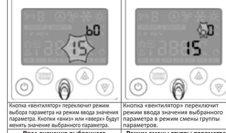
Кнопка «вентилятор» переключит режим выбора параметра на режим ввода значения параметра. Кнопки «вниз» или «вверх» будут менять значение выбранного параметра.
