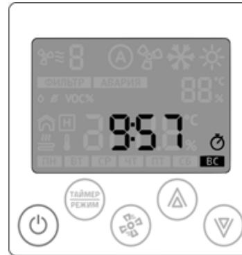
В дежурном режиме установка выключена. На экране панели отображается текущая дата, день недели, а также значок работы по расписанию. Для включения установки в работу необходимо кратковременно нажать на кнопку «Питание».
