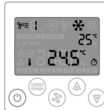
После нажатия кнопки питания контроллер переходит в режим работы. При этом отображается индикация включения вентиляторов и при соответствующих условиях нагревателя, текущий режим работы, уставка температуры и текущая температура, день недели. При работе по расписанию отображается соответствующий индикатор.
