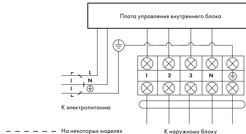
**Клемный терминал наружного блока**
