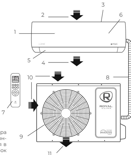
В комплект сплит-системы (кондиционера воздуха) входят: один внутренний блок кондиционера воздуха с пультом управления в упаковке, один внешний (наружный) блок кондиционера воздуха в упаковке, одна инструкция пользователя.
