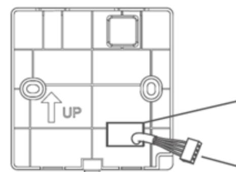
Отверстие на задней крышке
