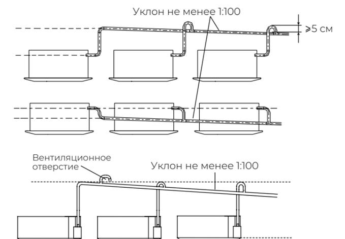
Убедитесь, что блок установлен с небольшим уклоном в сторону дренажной трубы.
