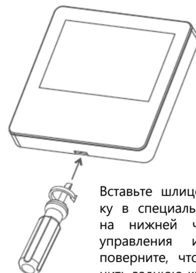
Вставьте шлицевую отвертку в специальную прорезь на нижней части пульта управления и аккуратно поверните, чтобы отсоединить заднюю крышку пульта управления.
