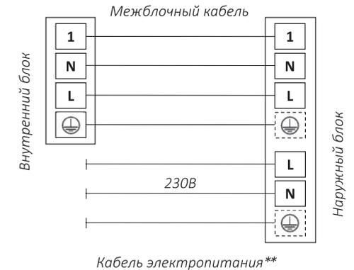
\*\* Кабель электропитания подключен к плате управления наружного блока блока
