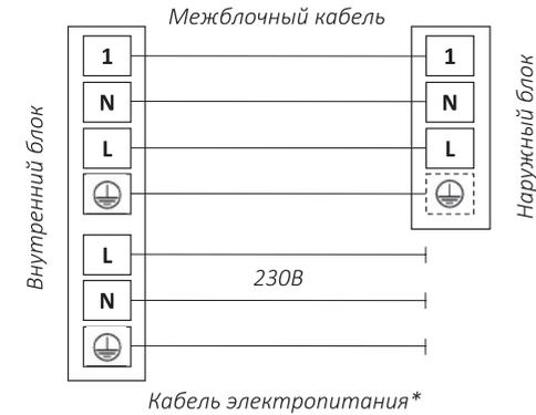
\* Кабель электропитания подключен к плате управления внутреннего блока блока
