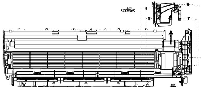
11. Disassembly fan motor and fan blade.
